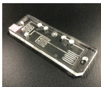
図 1 高速リアルタイム PCR 用マイクロ流体デバイス。
